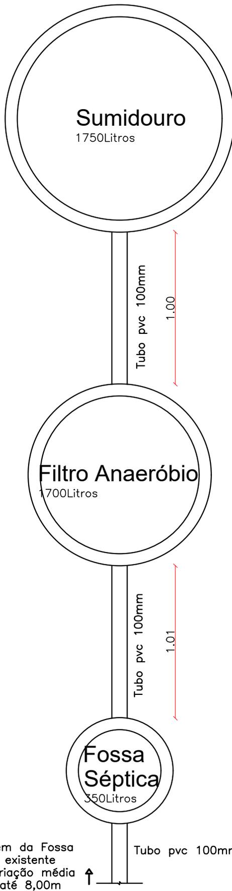
CONTEÚDO: Planta Baixa Fossa Séptica, Filtro Anaeróbico, Sumidouro
